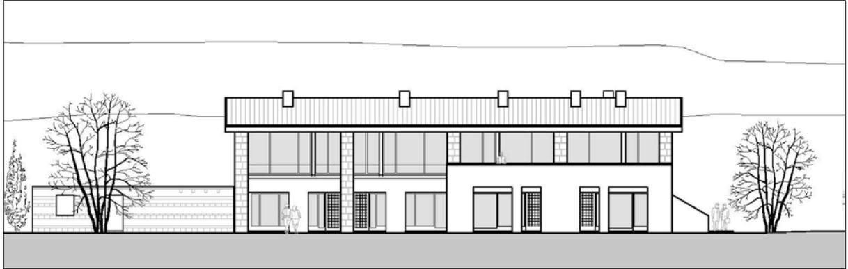
Riprendendo i caratteri tipologici dell'architettura storica, l'edificio distingue l'attacco a terra, dal primo piano e dal piano di copertura: il tetto. In questo senso si distinguono nel progetto le pareti rivestite in pietra al piano terra, che riguardano anche il corpo scala disposto a nord, dall'involucro del primo piano e dal coronamento, costituito dal tetto che, secondo la tradizione umbra, è costituito da due falde rispettivamente rivolte a sud e a nord.
