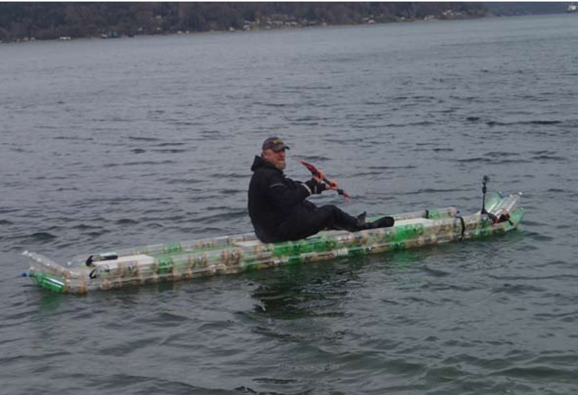
Barco com garrafas de plástico em autoconstrução.
